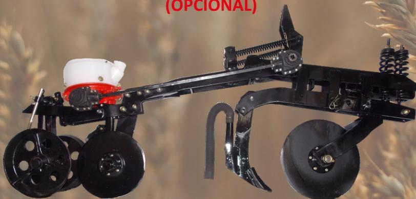
As linhas são montadas defasadas uma da outra, possui dupla pressão de corte, com discos duplo da semente defasado e desencontrado permite o plantio direto e convencional, dupla mola de pressão para o disco da semente, sulcador com pula pedra e modo fixo, pode ser colocado Arme-Desarme, a transmissão é através de engrenagens helicoidais com cardã.
